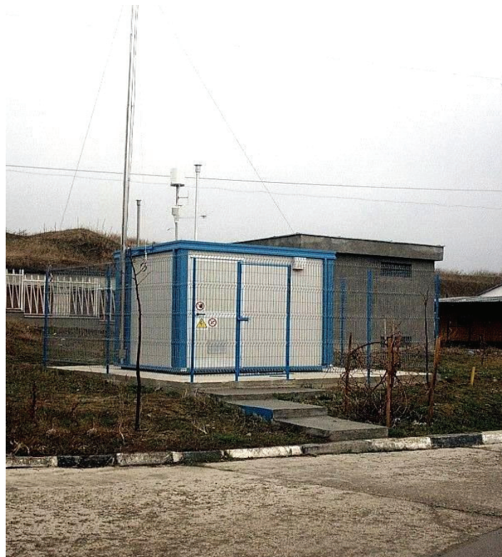
Fig. nr.1. Stație de monitorizare automată a calității aerului- fond urban
