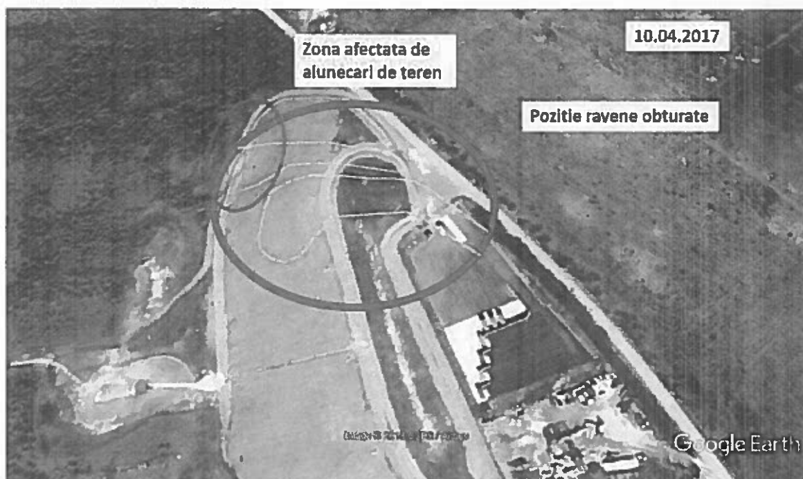
Fig. 8. Se observa aparitia alunecarilor de teren, in special in zona ravenei din nord, unde exista in 2006 si zona de baltire evidentiata in Fig. 3.
